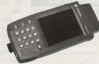
写真1 ●採用したPDA Windows CEを搭載したPocket PC「カシオ DT-5000」。無線LANインタフェースを内蔵し、オプションのバーコード・リーダーを装着している
